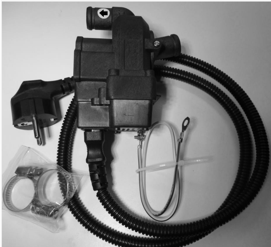
Bilde: Den øverste slangetilkoblingen er varmtvann ut, som spyles ut pga. innebygget sirkulasjonspumpe.
